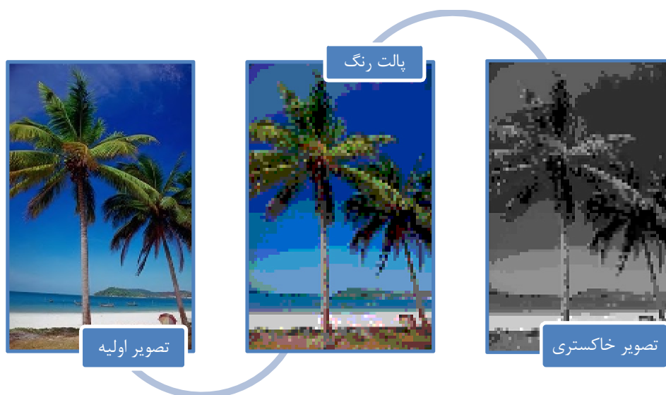
شکل ۵-۱۱ ناحیه‌بندی تصویر با استفاده از نگاشت از فضای RGB به پالت رنگ ۲۱۶ تایی
